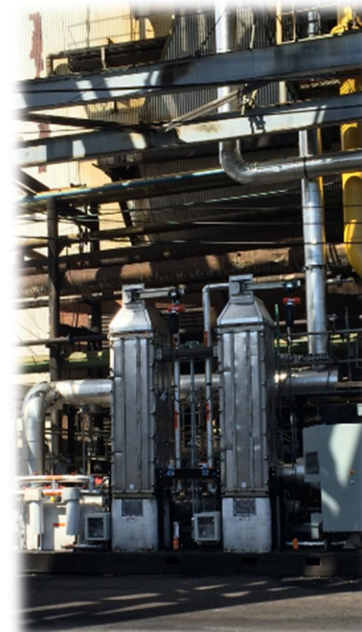
Instalacja pilotowa do konwersji SO 2 w elektrowni węglowej
